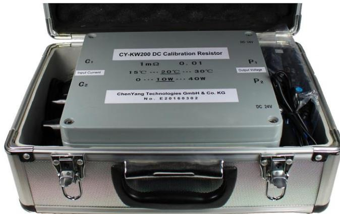
Vor Beginn der Messung, der Netzteil +24VDC muss mit dem Widerstand zur Regelung der Betriebstemperatur des Widerstands im Bereich von 15°C~30°C verbunden werden. Der Widerstand muss 45 Minuten vor der Verwendung zur Messung vorgeheizt.
